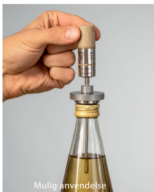
Temperaturmåling i en dåse/ flaske med loggeren monteret eksternt: testo 191-T2 + dåse- og flaskeholder
